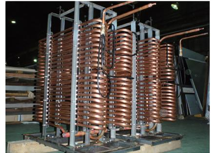
恒温水槽冷却用コイル
