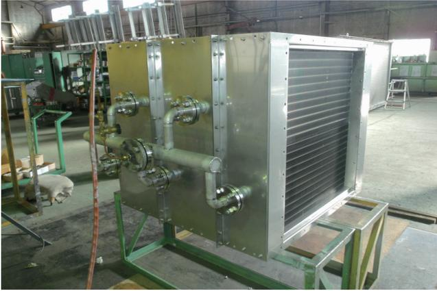
蒸気コイル・全ステンレス製
