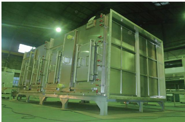
排気ガス冷却用・全ステンレス製
