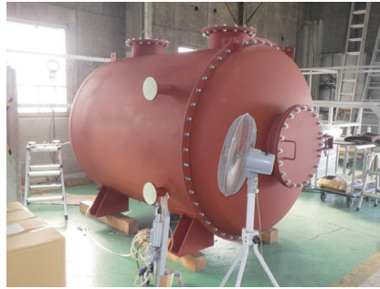
タンク型空調機
