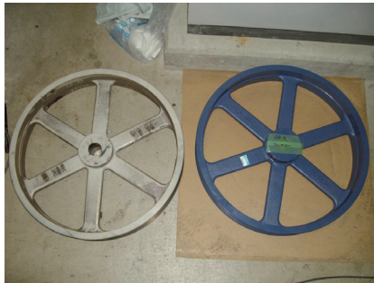
交換前後のプーリー
