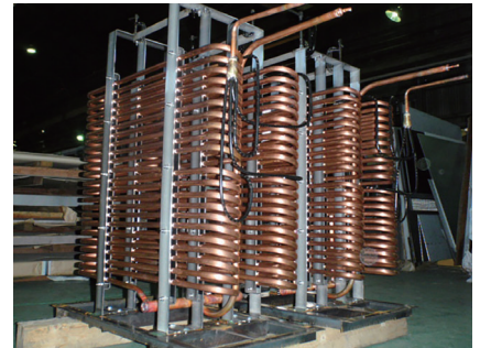
恒温水槽冷却用コイル
