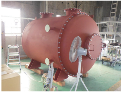
タンク型空調機
