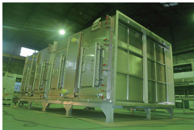
排気ガス冷却用・全ステンレス製
