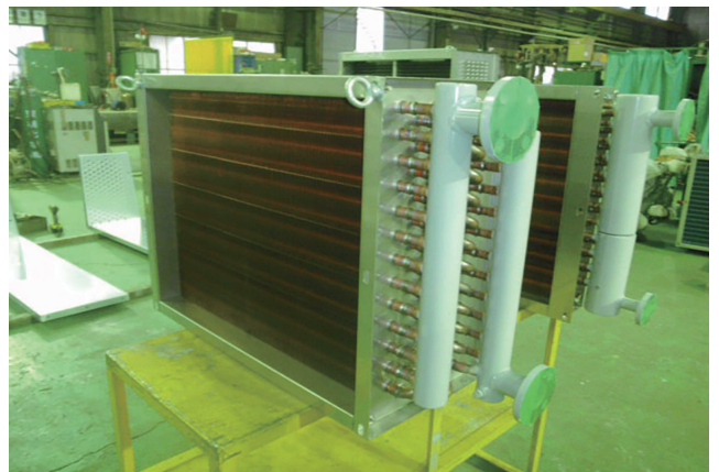
冷温水コイル・銅管・銅フィン
