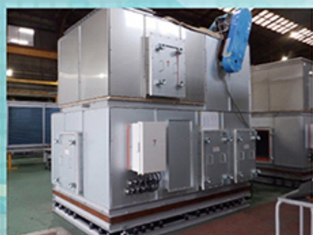
環境試験用空調機
